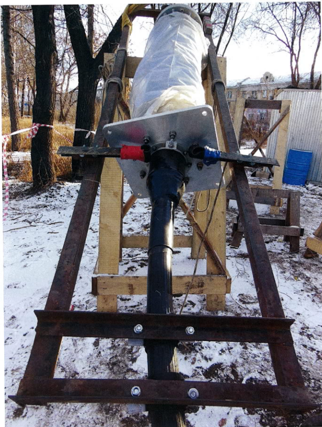
Рис. 5. Крепление нижней части МКВ 126 и кабеля на приспособлении
