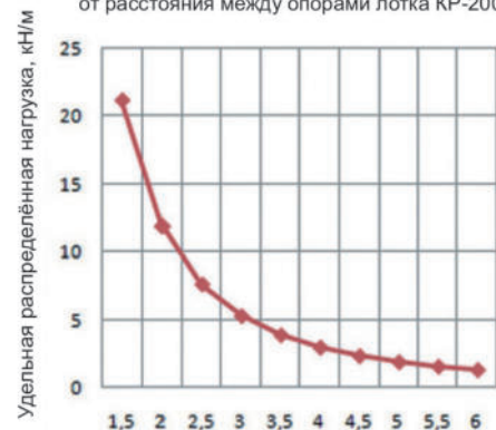
График зависимости удельной нагрузки от расстояния между опорами лотка КР-200
